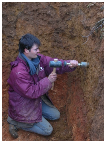
Photographie 3 : Mesure de la densité apparente du sol
