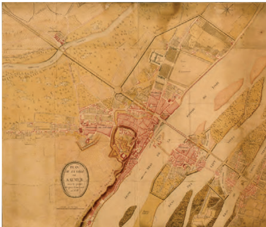
Plan de Saumur indiquant les ponts anciens (aujourd'hui détruits) et l'emplacement de la traversée nouvelle, rectiligne. Au XIX e siècle, le bras des Sept-Voies sera comblé supprimant la nécessité d'un pont en cet endroit. Dessin aquarellé, vers 1770. Paris, AN, F14/10200, pièce 2.
