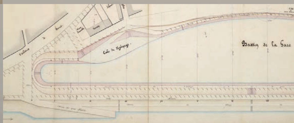
Projet non approuvé d'une gare dans le port d'Orléans, rive gauche en aval du pont George V. Cette gare devait contenir 210 bateaux. Plan dressé par l'ingénieur Coumes le 23 avril 1850 (AD 45).
