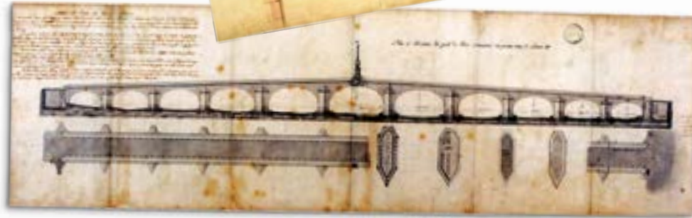
À BLOIS, LE PREMIER D'UNE NOUVELLE GÉNÉRATION Plan et élévation du pont de Blois commencé le premier may 1717. Archives départementales de Loir-et-Cher.
